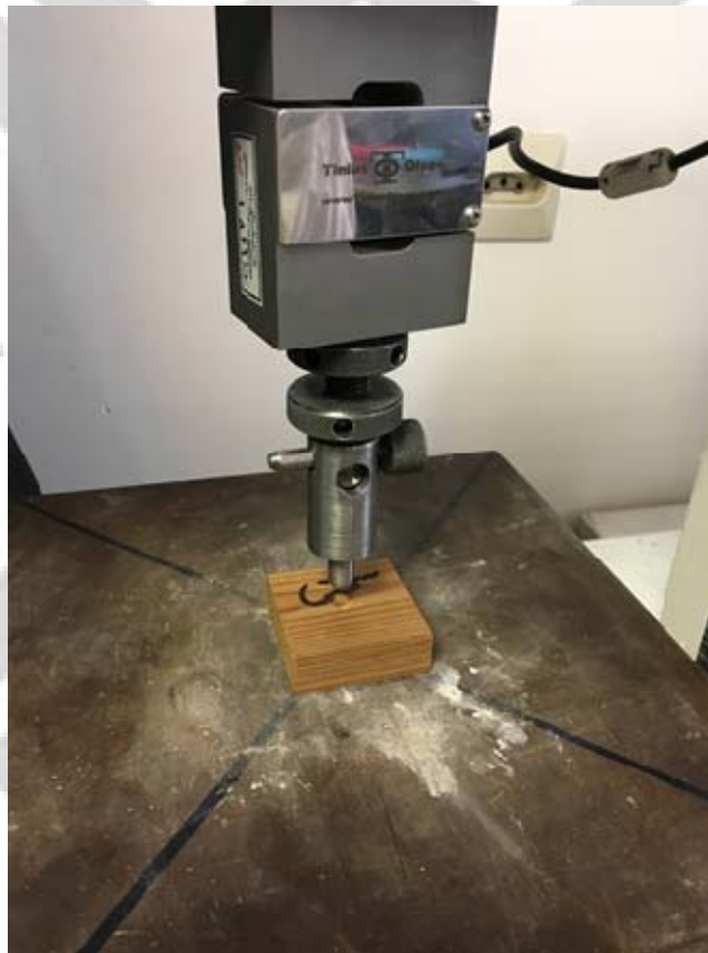
شکل ۸- روش انجام آزمون تعیین سختی
